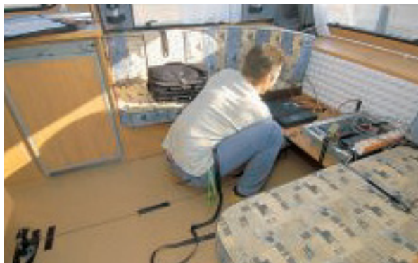
Im Testcaravan wurden Sensoren installiert, die Aufschluss über die beim Pendeln auftretenden Querbeschleunigungen geben.
