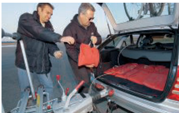
Im zweiten Versuch wurde ein Teil der Ladung aus dem Caravan in den Zugwagen umgeschichtet, mit positiven Auswirkungen auf die Fahrstabilität.
